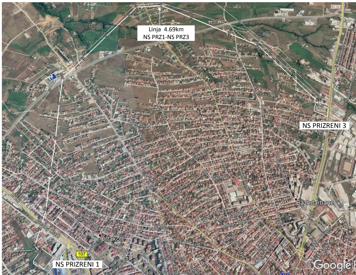
Figura 5-10 Linja 110 kV NS Prizreni 1 – NS Prizreni 3 me gjatësi 4.69 km
