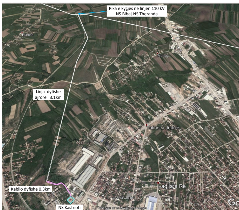
Figura 5-15. Konfiguracioni i kyçës së NS Kastrioti (Ferizaj 3) në rrjetin e transmetimit, traseja e përafërt e linjave kyçese
