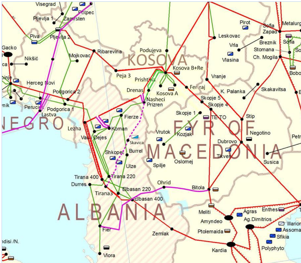
Figura 5-7 Shtirja gjeografike e projektit NS Nasheci në rrjetin regional e cila ndërlidhë rrjetin transmetues të Kosovës me katër unaza 400 kV (rrathët e kuq me vija të ndërprera)
